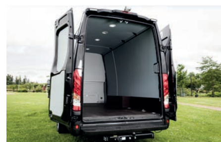
Tavaratila on eristetty ja vaneroitu.
